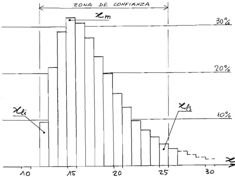
FIGURA n.º 3 PROBABILIDADES RELATIVAS DE LAS HIPÓTESIS DEL N.º. DE TROQUELES "x" PARA QUE RESULTE LA MUESTRA: C=22, d=12
